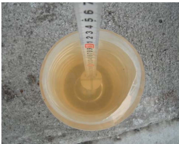
【写真１】手作り透視度計による透視度の簡易測定
