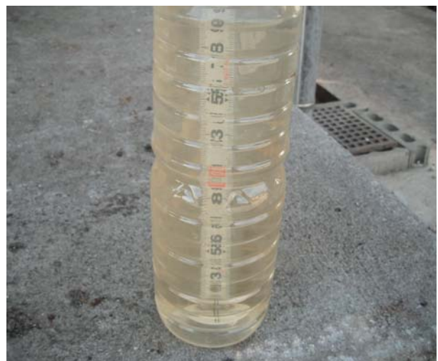
【写真１】手作り透視度計による透視度の簡易測定
