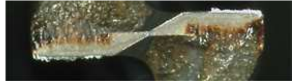
(b) 粉末ハイス Non-Step 加工(切削速度 10m/min)
