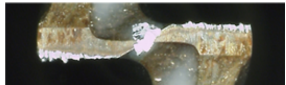
(e) 粉末ハイス Step 加工(切削速度 10m/min)
