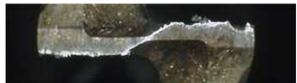
(d) SUS 用ハイス Step 加工(切削速度 14m/min)
