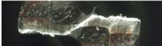
(d) 粉末ハイス Step 加工(切削速度 10m/min)
