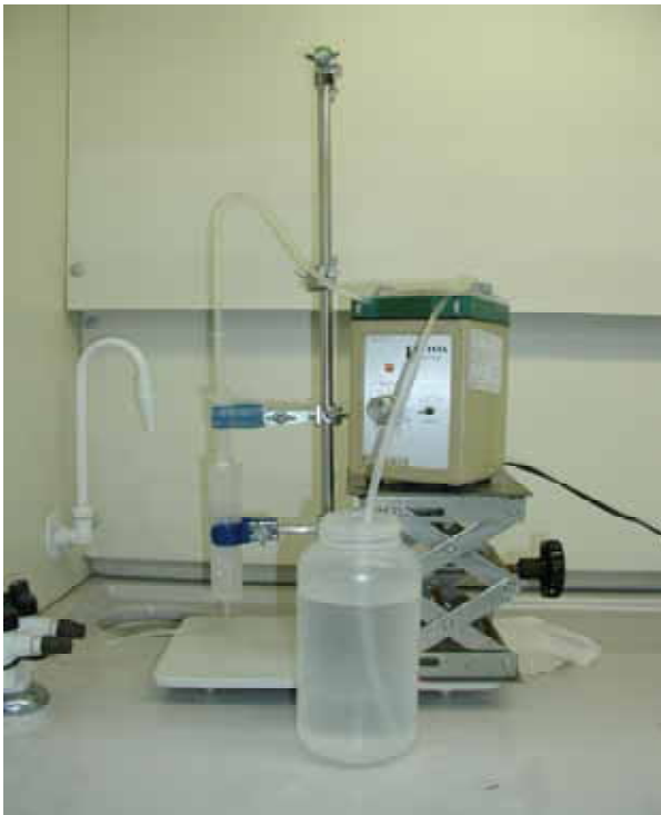
図11 ペリスタポンプによる試料通液
