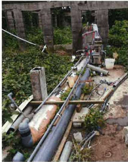
図1 小型メタン発酵槽 (70L) 外観
