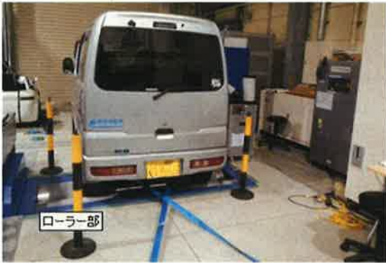
図1 シャーシダイナモメータによる出力測定
