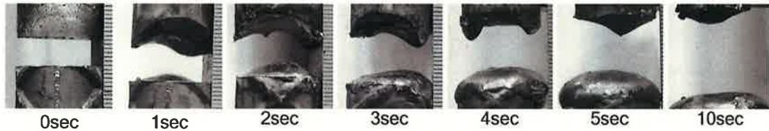
図3 アーク発生時間とギャップの変化の例
