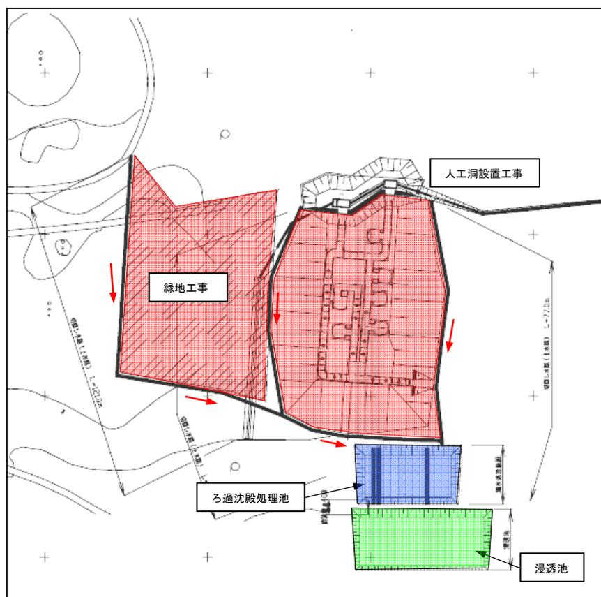
図 2-14 人工洞設置工事及び植栽工事（グリーンベルト）における濁水対策施設
