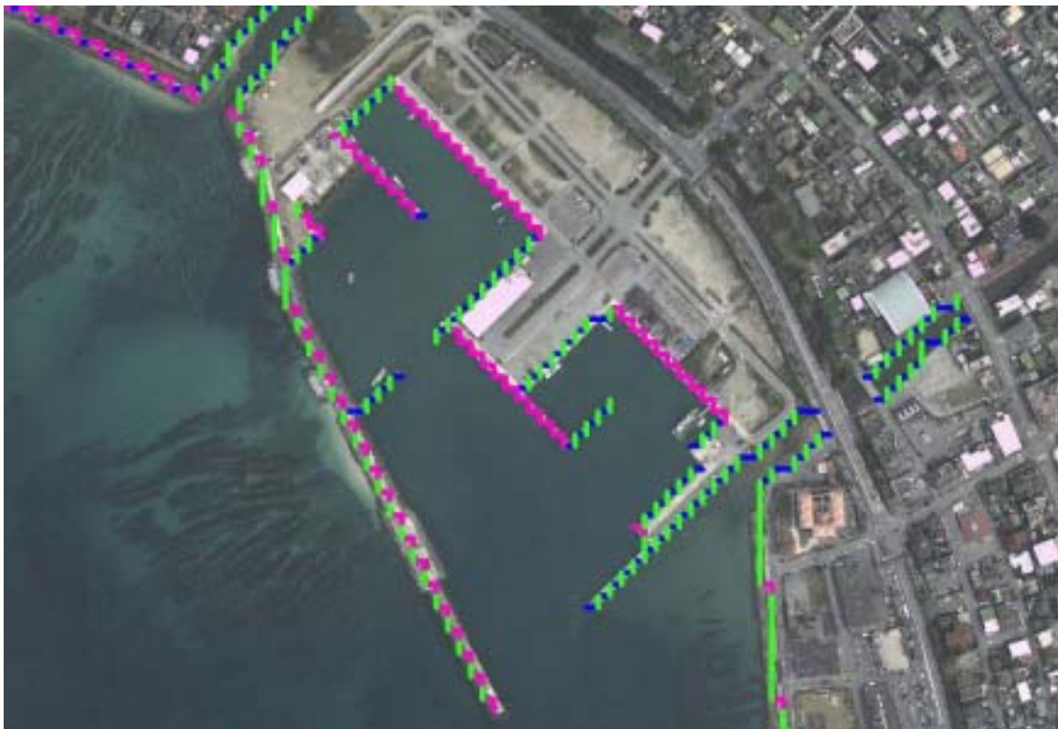
図 3.4-1 構造物データ(メッシュ辺上にモデル化したブレイクラインデータ)の例
