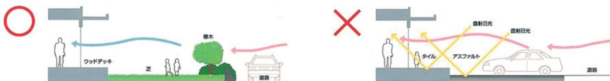
住宅周辺に樹木の植栽をすることで、日射の照り返しや暖まった地表面からの熱放射が抑えられ、空気が暖まるのを防ぎます。大きな窓に面してタイル敷きのバルコニーやアスファルト舗装の駐車スペースなどがある場合は、室内への熱の影響をできるだけ軽減できるように、照り返す面の材料や仕上げを芝生やウッドデッキ等にする工夫が望まれます
