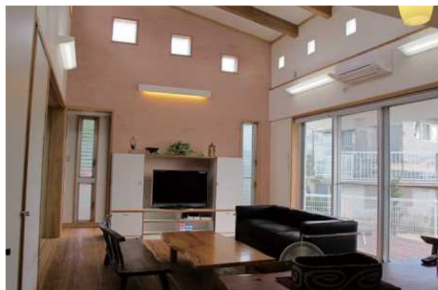
漆喰は瓦のおさえ材でもあるが、 調湿機能のある内装材として使用
