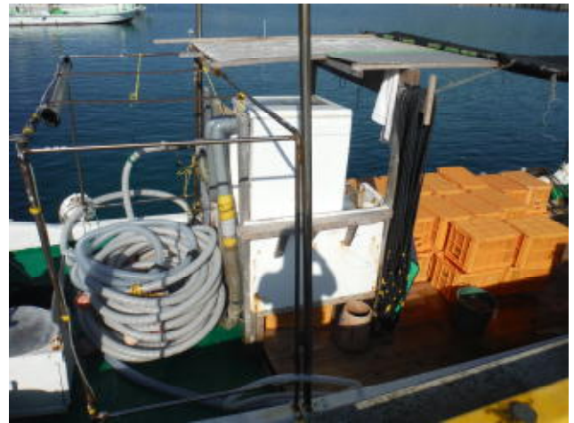
図16. モズク船上異物除去機搭載状況
