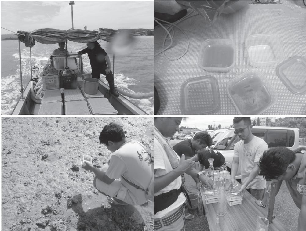
図4 赤土サンプルの採集状況。上段は左右ともに東村川田での沖合定点での様子。下段は、恩納村屋嘉田での底質サンプル採集（左）と SPSS 簡易測定法により底質中の懸濁物質含量を測定している様子（右）。
