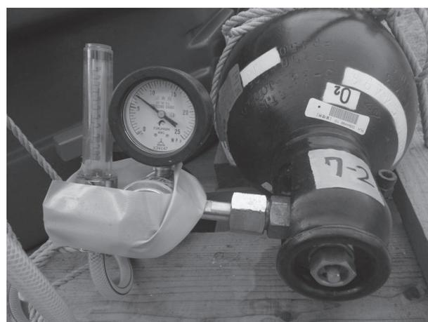
写真 タンク設置の様子及びガムテープによってつまみを固定したレギュレーター
