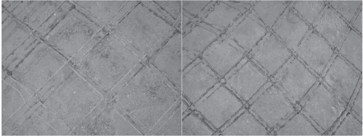
図 4 張り出して 90 日後の網の様子。左は網洗浄を 4 回実施済みで、右は洗浄を行っていない。洗浄なし（右）は密度が高いことが分かる。
