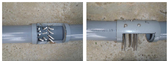
④異物除去器D (勝連式②VP65ジョイント ステンレスネジ5mm×11)
