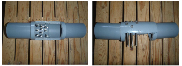
②異物除去器B (勝連式②VP65ジョイント ステンレスネジ5mm×10)
