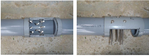
⑤異物除去器E（勝連式②VP65ジョイントステンレスネジ5mm×8）
