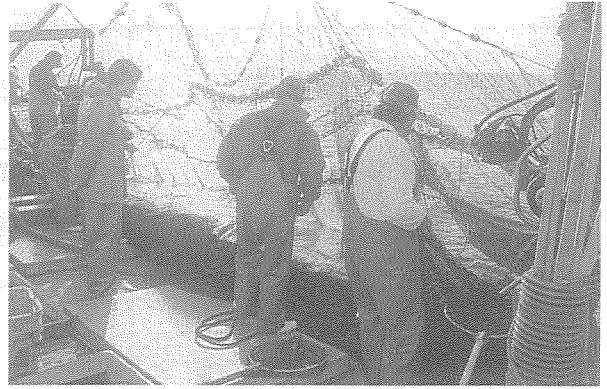
④袋網の端をクレーンで吊り上げる
