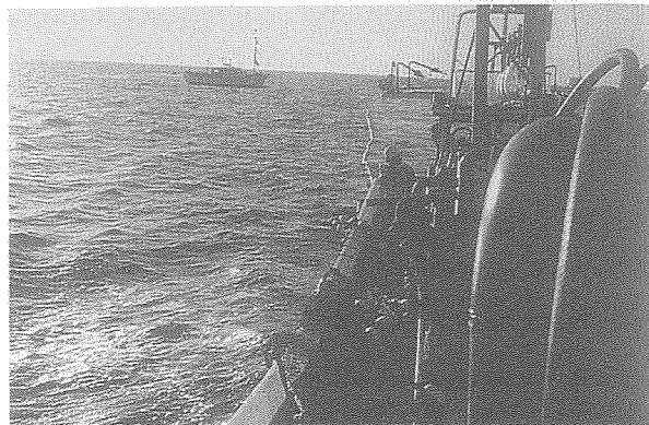
1. 手前は網船、遠くは片船、潮上げより網船は袋網、袖網を投下、片船は投下された袋網端のつなぎ手に、自船の2段ロープをつなぎ、2段、1段ロープを走らせながら投下する。
