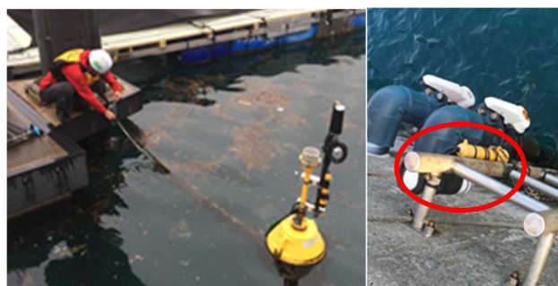
写真: ブイに設置された海上タイプの回収作業 (左) と岸壁のはしごに設置された陸上タイプの設置状況 (右, 赤丸のところ)
