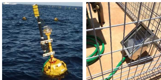
写真：ブイに設置された海上タイプ（左）と陸上設置タイプ（右）
