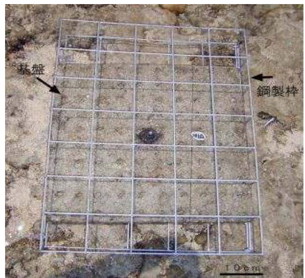
図2. 食害防除試験に用いた弁当箱型食害防止枠
