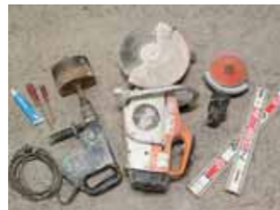
アスファルトを切るカッターや ドリルなど使われた道具の数々
