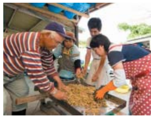
生ごみ飼料化作業風景。生ごみの中に異物がないか確認後、細かくカットしています
