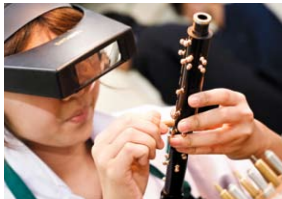
管体の小さな穴に一つひとつ手作業で部品が埋め込まれる
