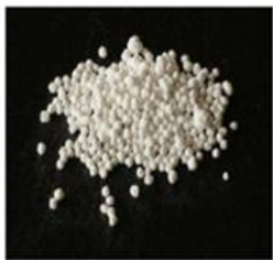
硬度低減施設により除去された カルシウム等の硬度成分（生成パレット）
