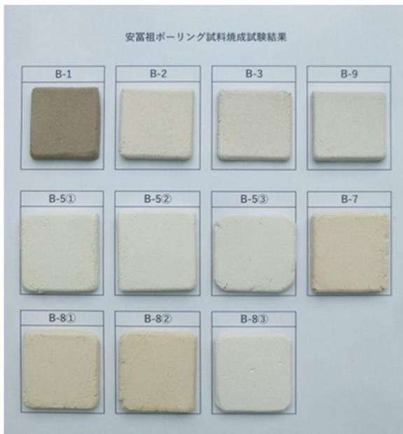
図5 焼成試験体 (1, 250°C)
