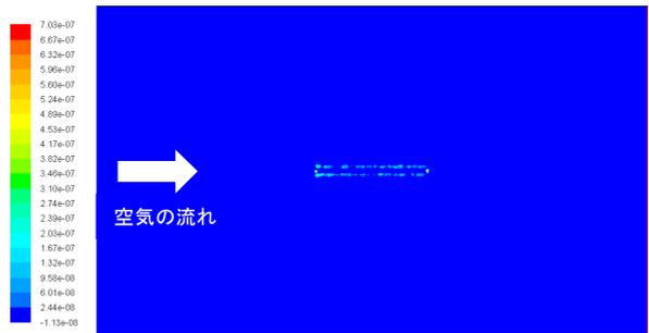
図10 蒸発量割合 (オイラーモデル)
