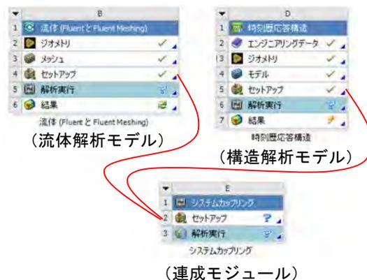
図2 システムカップリング手法のモデル構成
