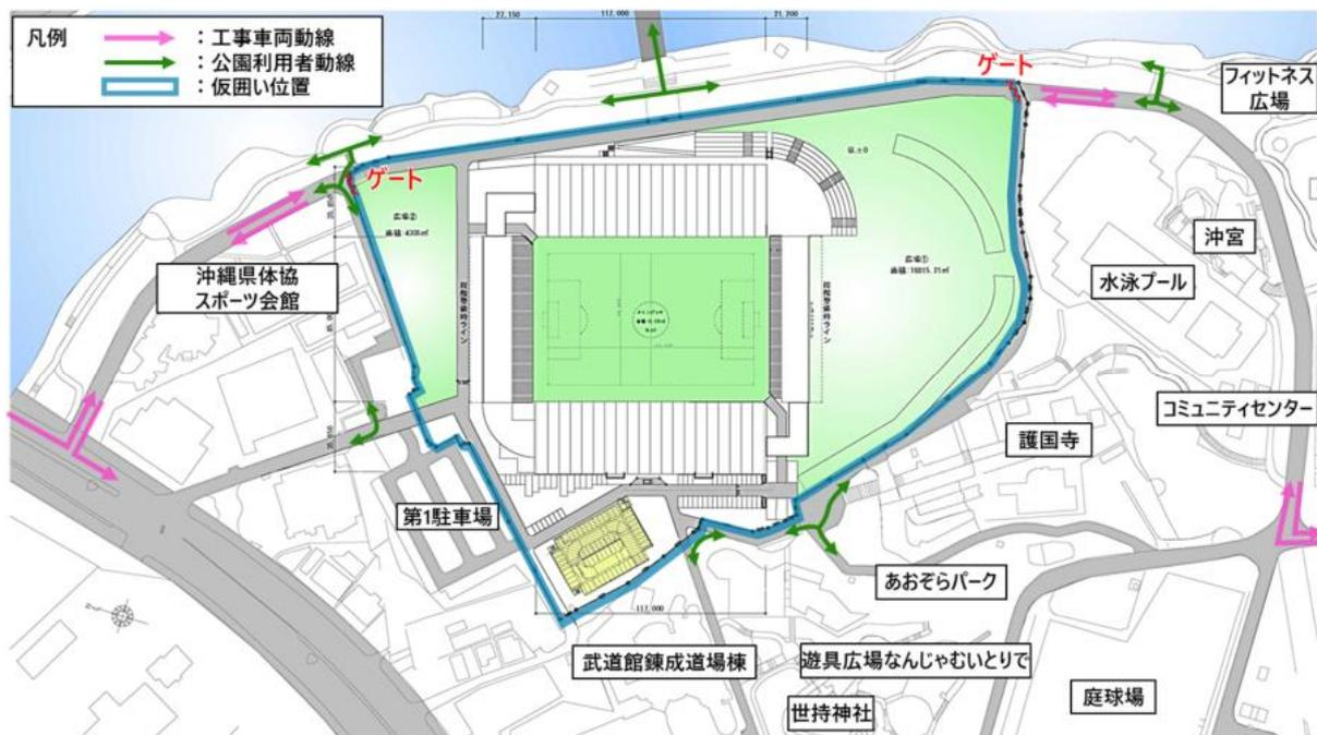
図 8 概略設計 動線計画 (当初整備・施工時)
