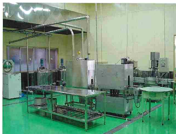
図2 パイロットプラント。1回で600Lの処理が可能です。
