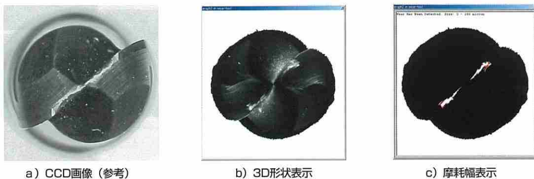
図2 計測表示例(直径6mmボールエンドミル先端)
