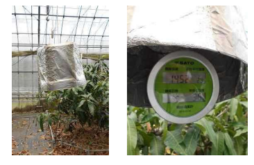
図4 積算温度計の設置状況
