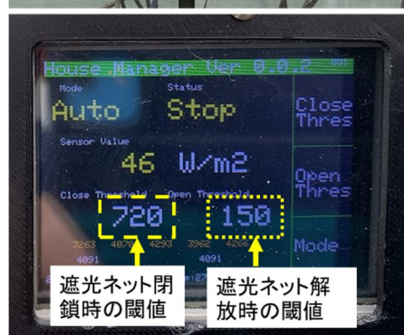
図 3 制御システム（上）と操作画面（下）
