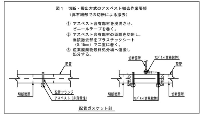
図1 切断・搬出方式のアスベスト撤去作業要領 (非石綿部での切断による撤去)
