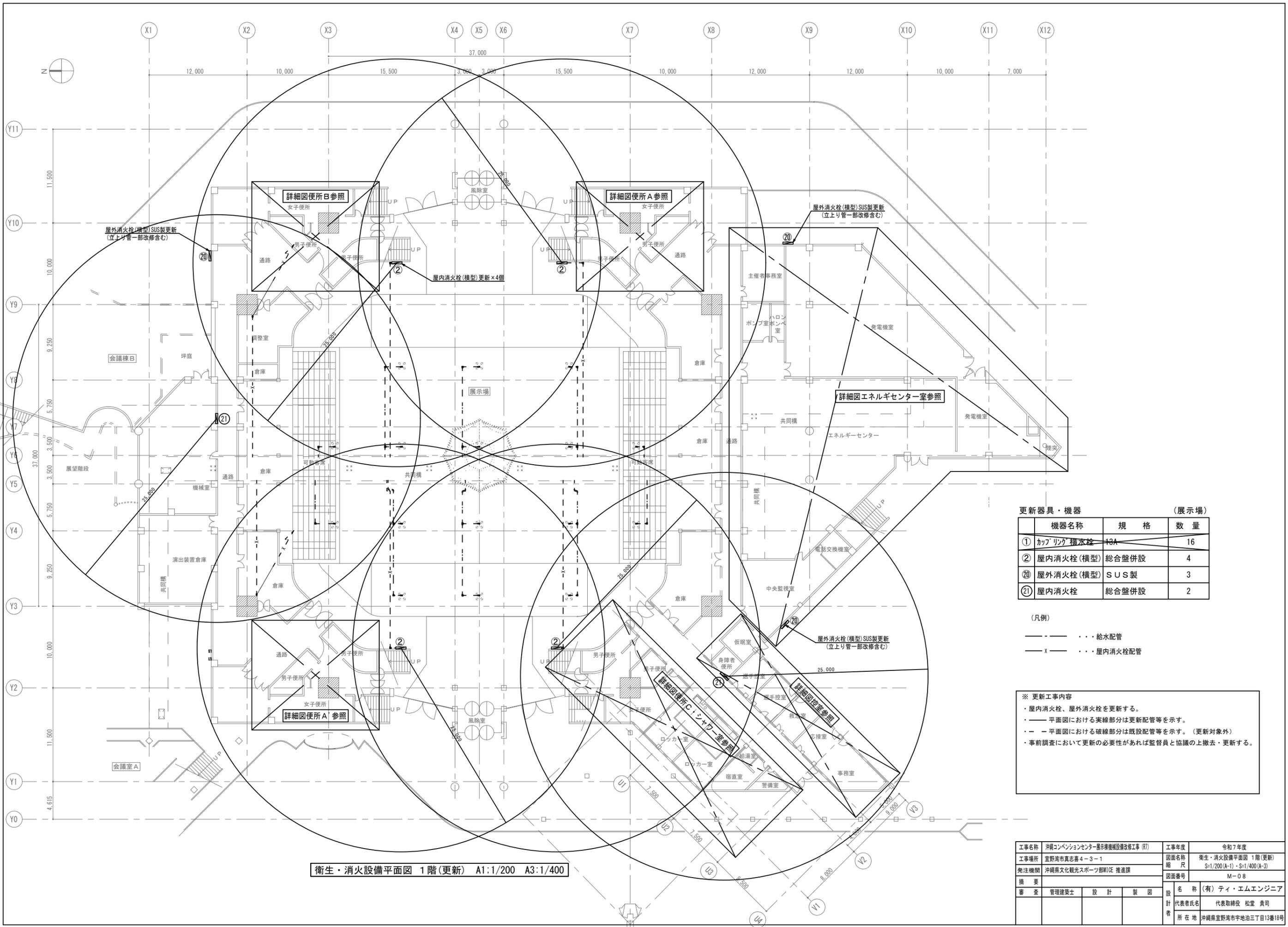
衛生・消火設備平面図 1階(更新) A1:1/200 A3:1/400
