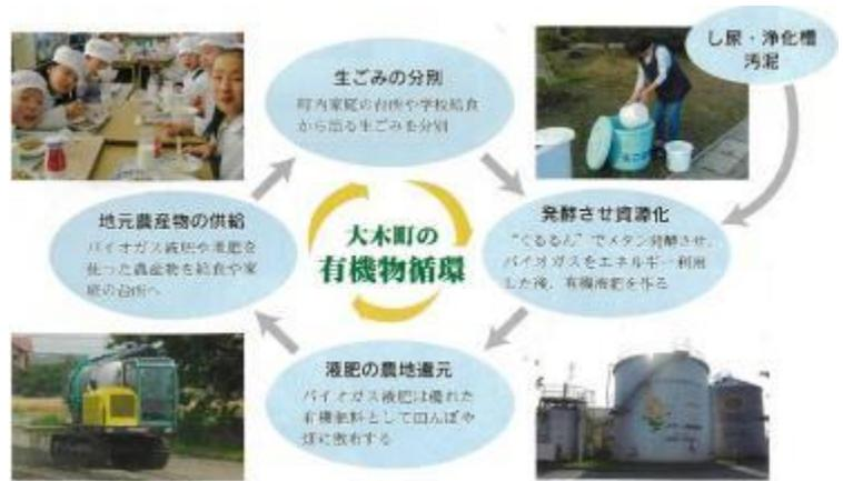
おおき循環センター「くるるん」は家庭から排出される生ごみ、し尿、浄化槽汚泥等をメタン発酵槽に受け入れ、発生したバイオガス(メタンガス)を利用して発電(電気と温水の供給)を行っている。また、発生した液肥は農地還元している。メタン発酵施設の概要を表4-3-2に示す。
