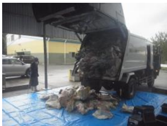
パッカー車による試料採取状況
