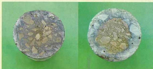
普通セメント使用 (内部まで塩素イオン浸透)
