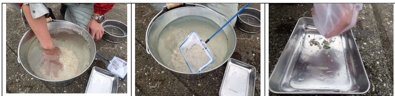
図 3.4-5 ネットによる分別作業
