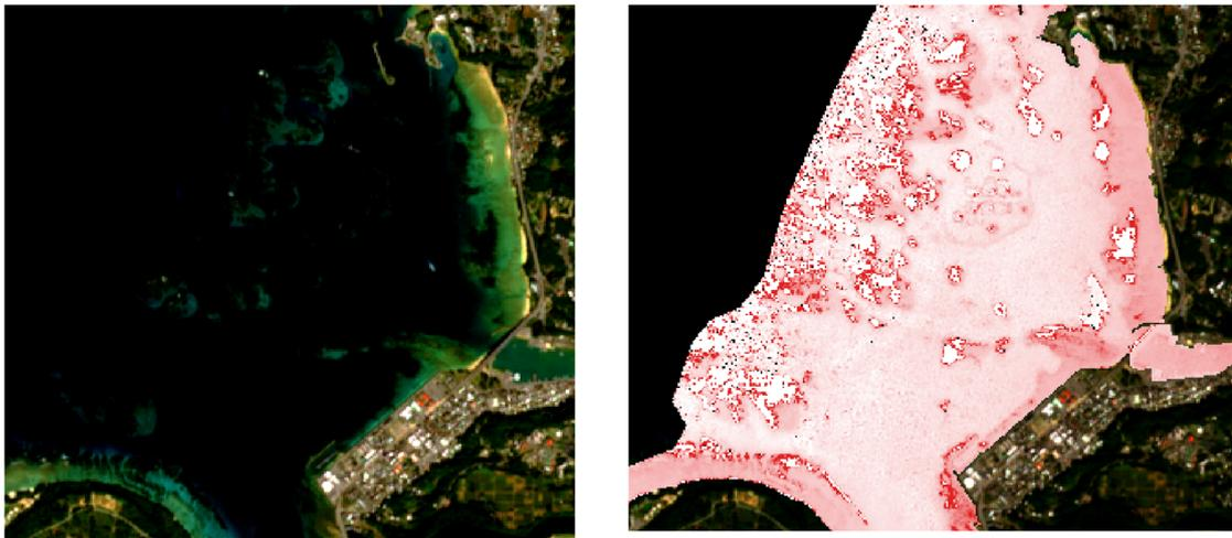
図 3.1.4-3 岩盤帯(離礁)での誤った赤土堆積量推定例
