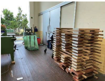
図-1 天然乾燥試験の棧積み状況 （中段：ホルトノキ）
