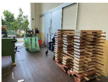
図-1 天然乾燥試験の棧積み状況
