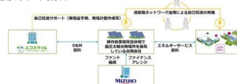
注3：自己託送とは、遠隔地にある自社所有の太陽光発電設備で発電された電気を、送配電事業者の送配電設備を利用して自社または自社グループ企業の施設へ送電する仕組みのこと
