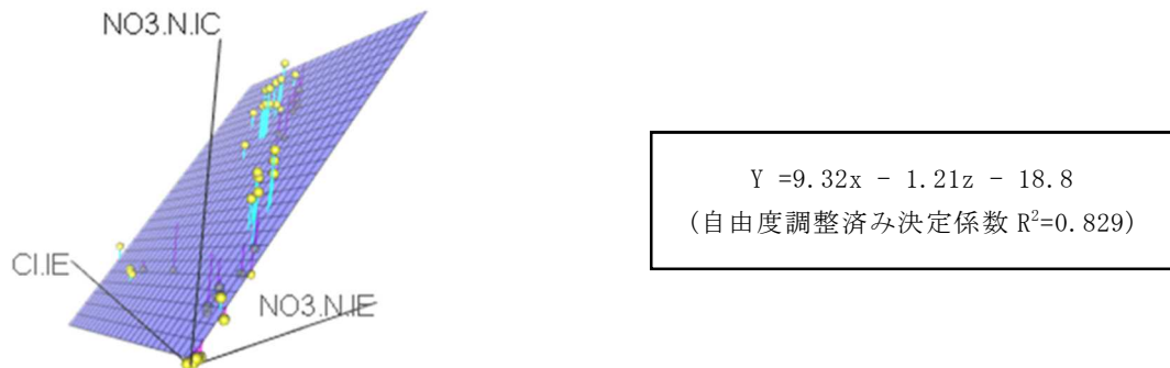
図6 NO 3 -N 推定モデル(重回帰モデル, n=48)
