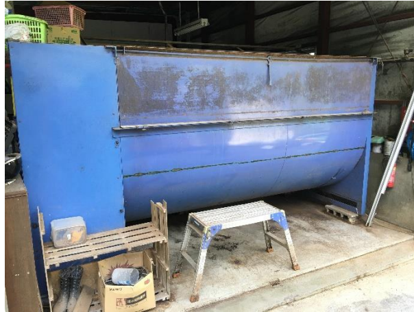
図-8. 菌床きのこの培地調製に用いる攪拌機
