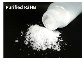
図10 R3HBの高純度結晶
