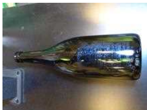
図2 リユース瓶の不良品(焼け)
