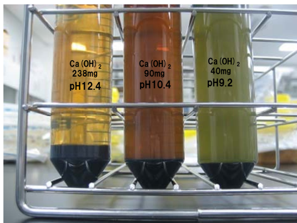
図4 タデアイ浸漬液からの消石灰による泥藍の調製
