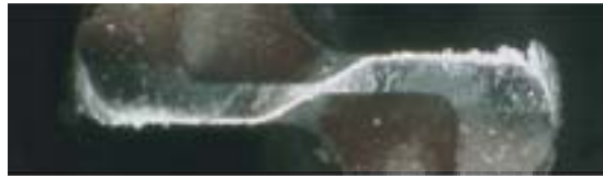
(a) SUS用ハイス Non-Step 加工(切削速度 10m/min)
