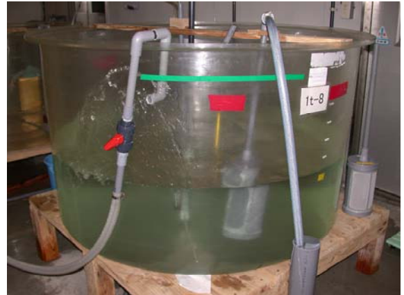
写真 1 注水と排水を同時に行う流水式全換水
