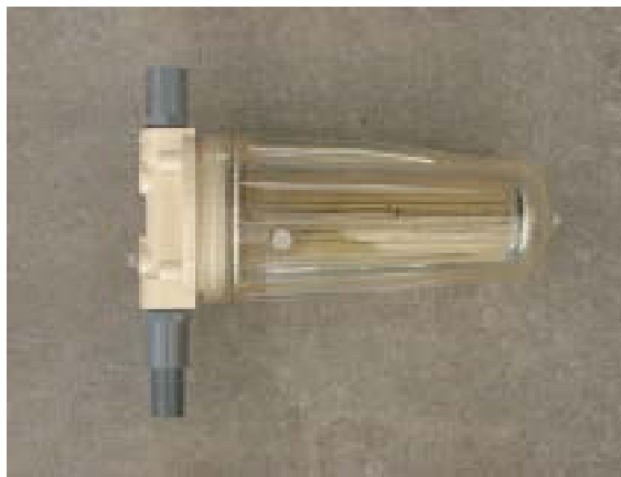
写真 1. 簡易ろ過装置
