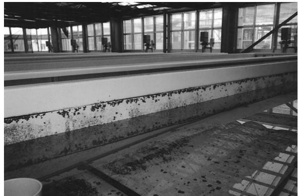
タフバンドを取り付けている水槽(水を落としたところ)
