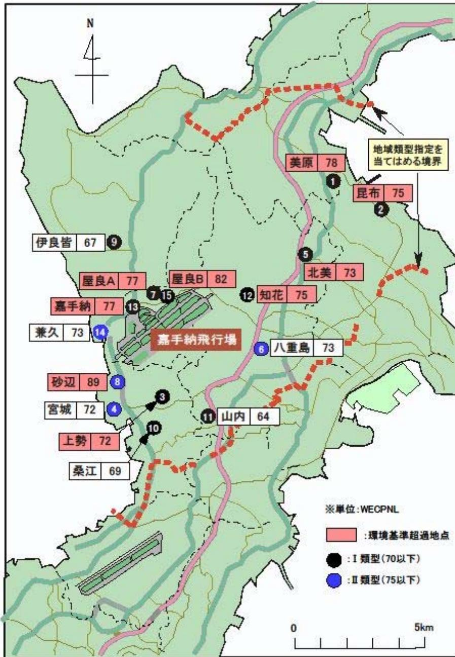
図7-2-1② 航空機騒音測定局配置図（普天間飛行場周辺）
