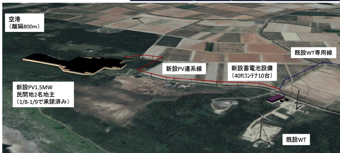
図 4-6 波照間島蓄電装置設置及び連系線接続イメージ
