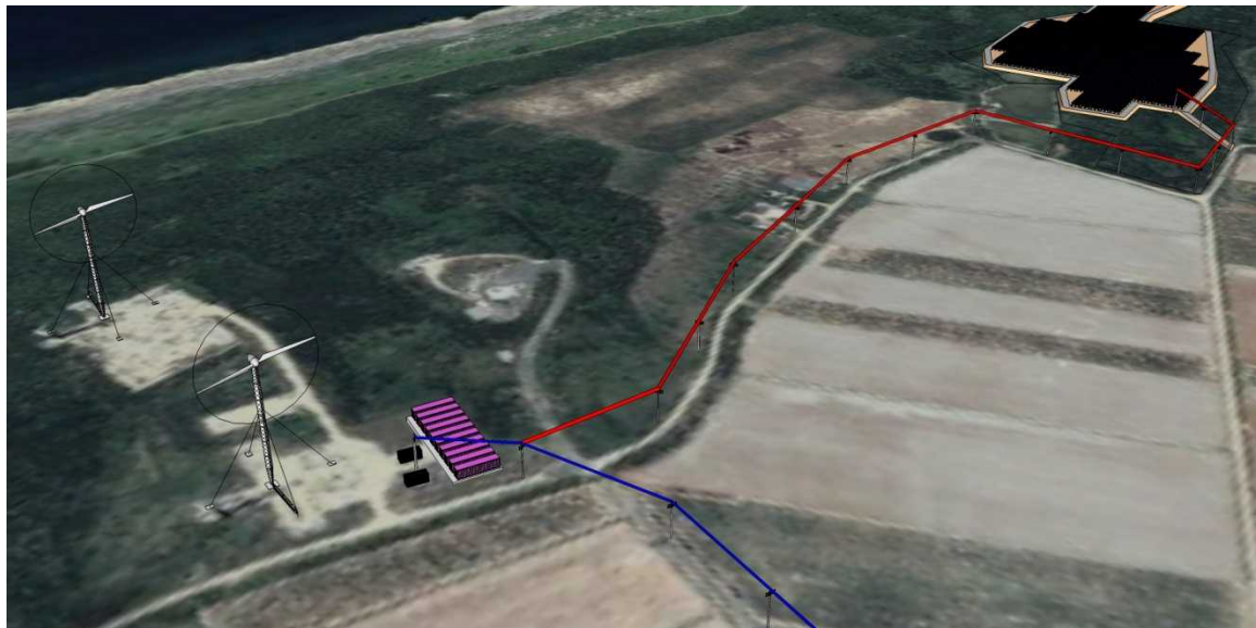
図 4-5 波照間島蓄電装置設置及び連系線接続イメージ
