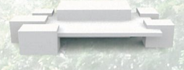
大屋根を BOX で囲んで支える
