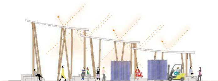
大きな1枚屋根にしてしまうと屋根下の空間が暗くなる恐れがあることから、屋根レベルを変化させ3分割することにより、レベル差を作りこれを北側に配置する。これにより柔らかい光が屋根の下に落ち、荷捌きだけでなく、屋根の下に集う人たちにも心地よい空間とする。
