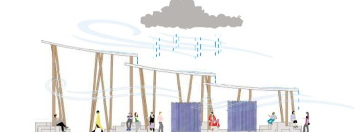
港に計画することから、潮風が通り抜けるように壁を設けない計画とした。また、台風時や風が強い日を考慮し、屋根に勾配を付けて上方向に風を誘導することで、バッファゾーン的な役割を果たす。既存ターミナルの建具等の破損を抑制、防止することの役割も担う建築物となる。
