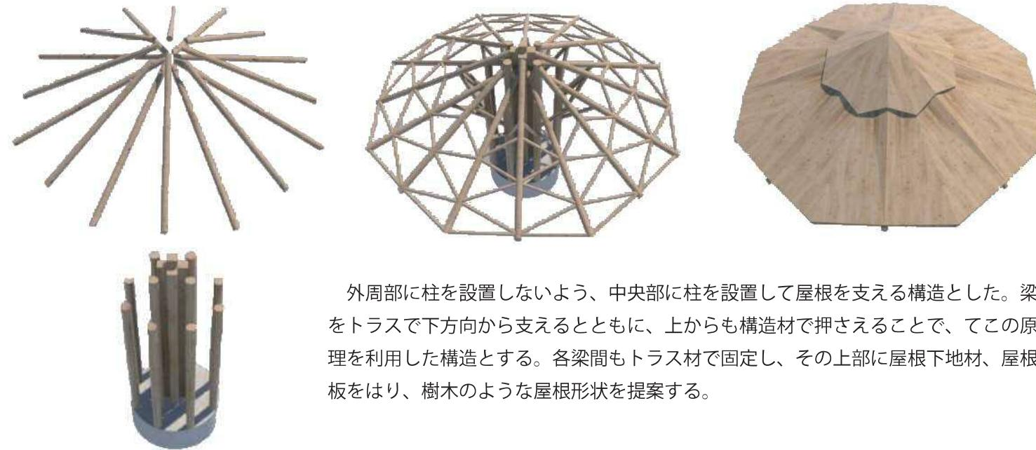
外周部に柱を設置しないよう、中央部に柱を設置して屋根を支える構造とした。梁をトラスで下方向から支えるとともに、上からも構造材で押さえることで、てこの原理を利用した構造とする。各梁間もトラス材で固定し、その上部に屋根下地材、屋根板をはり、樹木のような屋根形状を提案する。
